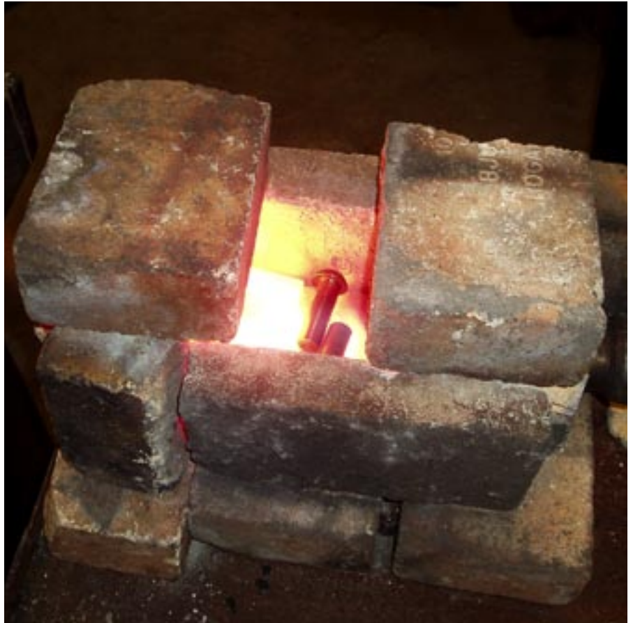
Värmning av nit i enkel gasolugn.
