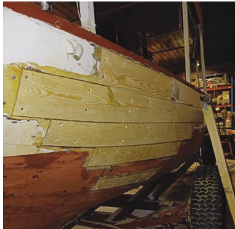
Stora delar av bordläggningen behövde bytas.
