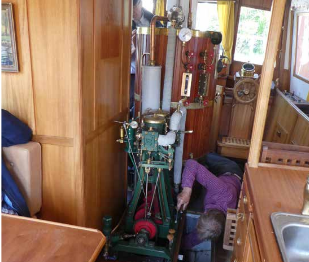
Yngve kopplar om från el- till ångdrift på Golden Gate. Ny maskin och panna.
