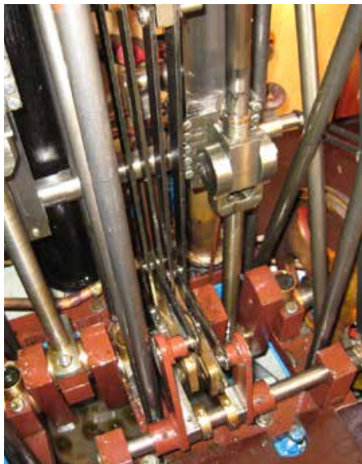
Finks Slidstyrning. Bågern sitter på exentern.
