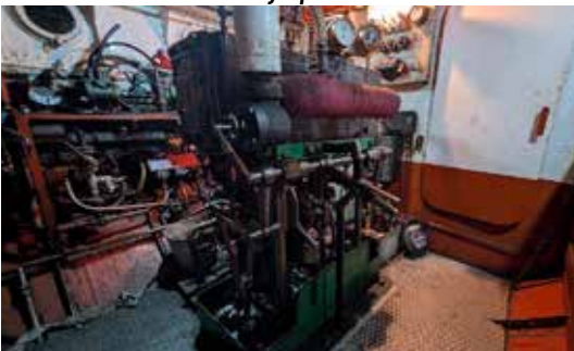
Tvåcylindrig comoundmaskin från 1919.
