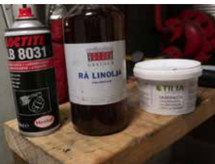
Lockticht, rå linolja samt skärpasta för rengöring och smörjning.
